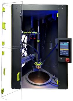
D-PATCH zeichnet sich durch einen automatischen Werkzeugwechsler aus, womit Multi-Material-AM mit bis zu fünf Materialien möglich ist. So können neben farbigen vor allem funktionelle Bauteile hergestellt werden.
